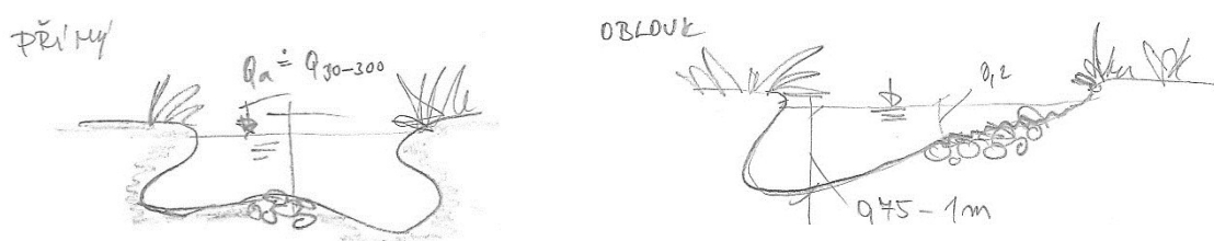
obr. 7 - Vzorový řez revitalizovaným korytem v přímé trati a v oblouku
