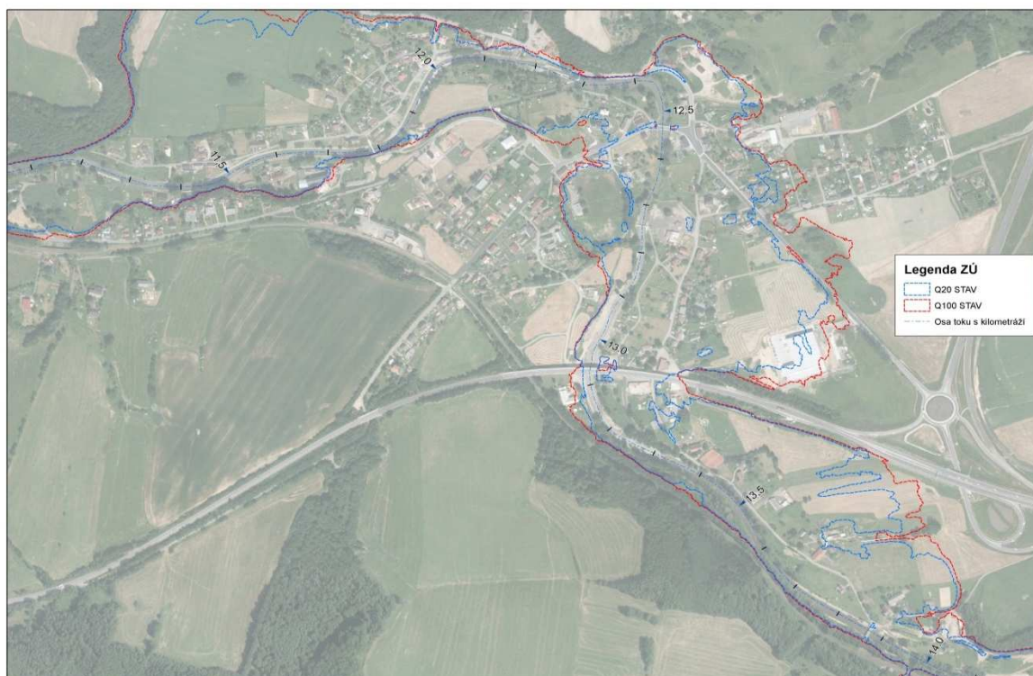
Obr. 10 Ohrožení v ř. km 11,100 - 14,000
