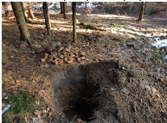
sonda KS 2 s vytěženými kameny žuly
