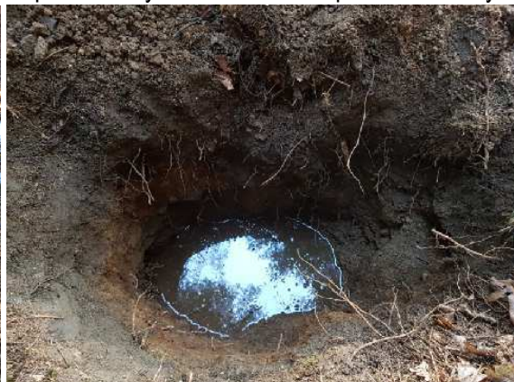
profil sondy KS 2 s hladinou podzemní vody
