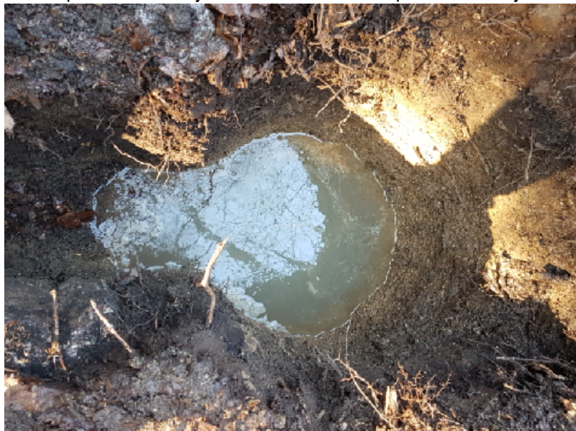
pohled do sondy KS3 s hladinou mělké podzemní vody
