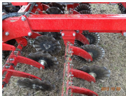
Obr. 8 Disky prořezávají drážky pro zasetí semen
