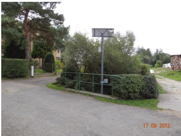
Automatický hlásný profil na mostku u garáží.
